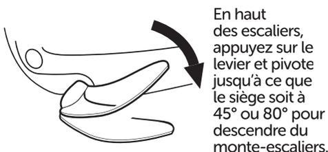
En haut des escaliers, appuyez sur le levier et pivote jusqu'à ce que le siège soit à 45° ou 80° pour descendre du monte-escaliers.
